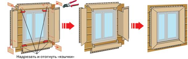
При монтаже околооконной планки создать зазор минимум 3 мм между ее торцами и горизонтальными смежными поверхностями.
