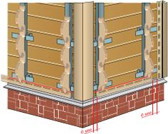
2 При монтаже фасадной системы серии Виниловое бревно Holzplast обязательно используйте крепежный профиль.
