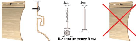
4 Иногда для крепления коротких резанных панелей нет другого способа, кроме как крепления его сквозь винил. В этом случае пробейте овальное отверстие в нужном месте специальным инструментом или подручными средствами.
