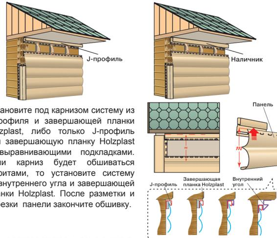
Установите под карнизом систему из J-профиля и завершающей планки Holzplast, либо только J-профиль или завершающую планку Holzplast с выравнивающими подкладками. Если карниз будет обшиваться софитами, то установите систему из внутреннего угла и завершающей планки Holzplast. После разметки и обрезки панели закончите обшивку.
