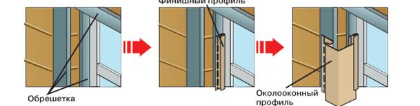
В верхнем и нижнем околооконном профиле в полках откосов надрезать и отогнуть язычок.
