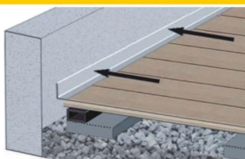
Для закрытия щели между террасной доской и стеной, а также для увеличения площади настила, вы можете использовать угловой профиль. Угловой профиль монтируется в стену!
