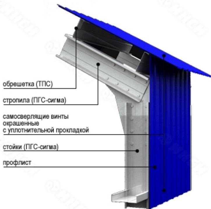
В случае, когда здание не требует утепления, **профлист выступает в качестве стены**, защищающей внутреннее пространство от ветра и осадков. В данном случае профлист крепится к стеновым ригелям каркаса самосверлящими болтами с уплотнительной прокладкой. **Крепление профнастила** производится через одну волну в нижний прогиб, стыки профлистов скрепляются заклепками с шагом 300мм.
