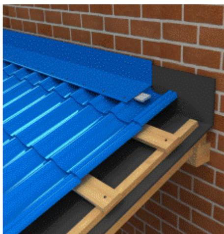
Для заделки примыкания скатов кровли к стене используются планки стыков и швов. Они крепятся в верхнюю точку волны металлочерепицы и сбоку на примыкающую стену. Нахлест планок по длине - 100мм. Дополнительное уплотнение примыканий планок к стене выполняется силиконовой мастикой.
