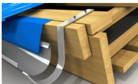
Монтаж крюков, желобов, труб производится по инструкции производителя-поставщика водосливной системы. Примечание! При использовании водосливной системы необходимо до монтажа листов металлочерепицы установить на доски обрешетки у карниза крюки для крепления желобов.
