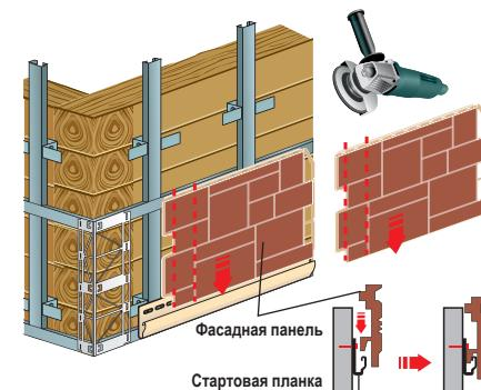
**3.1** Панель вставьте опорными штырями в стартовую планку и выровняйте ее по углу. Панель зафиксируйте на стартовой планке так, чтобы она имела свободу передвижения по ней при изменении температуры.
