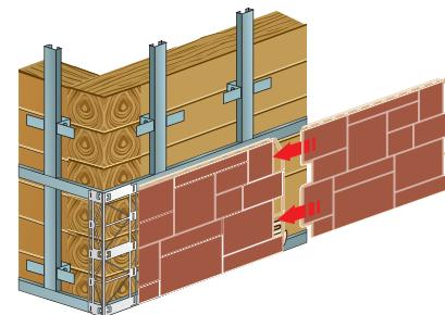
**3.2** Вторую панель заведите в стартовую планку и вплотную придвиньте ее к первой закрепленной панели, чтобы получить естественный рисунок. Последующие панели монтируйте аналогичным образом.
