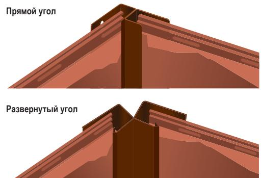
Используйте два J-профиля для обрамления внутреннего угла. Закрепите гвоздь или саморез в верхней части перфорации. Остальные саморезы устанавливайте по центру отверстий. Шаг монтажа выдерживайте 150-200 мм. Вставьте фасадную панель в J-профиль.
