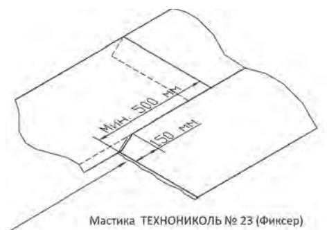
Следует обращать внимание на расстояние между торцами соседних полотен. Торцевые нахлесты соседних полотен материала, должны быть разнесены минимум на 500 мм. Торцевой нахлест составляет 150 мм.
