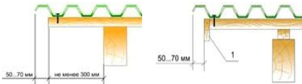
Рис. 6 Поперечный разрез фронтона
